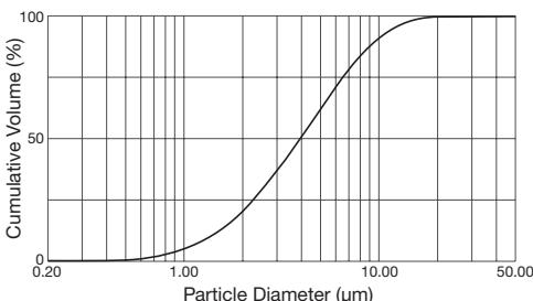
Die Messungen wurden mit einer Natrium-Chlorid-Lösung mittels Laser-Diffraktions-Methode durchgeführt. Das Diagramm ist möglicherweise so nicht auf Suspensionen oder sehr zähflüssige Medikamente anwendbar. Nähere Informationen dazu können Sie vom jeweiligen Medikamentenhersteller erfahren.
