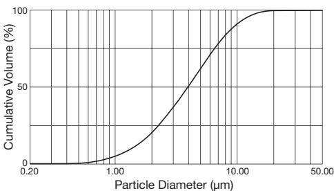
Измерения производились с использованием раствора хлорида натрия методом лазерной дифракции. Возможно, диаграмму не следует применять в отношении суспензий или очень вязких лекарственных средств. Более подробную информацию по этому вопросу можно получить у изготовителя лекарственного средства.
