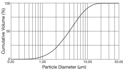
Las mediciones se han realizado con una solución de cloruro sódico utilizando un método de difracción láser. Probablemente de esta manera el diagrama no se puede aplicar en suspensiones o con medicamentos muy viscosos. El fabricante del medicamento correspondiente puede facilitarle más información al respecto.
