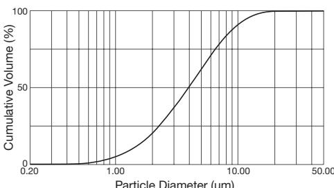
Pomiary zostały wykonane z zastosowaniem roztworu chlorku sodu, przy użyciu metody laserowo-dyfrakcyjnej.
