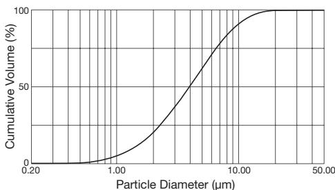
Ölçümler sodyum klorür çözeltisi ile lazerdifraksiyon yöntemi aracılığıyla gerçekleştirildi.
