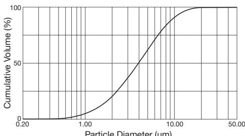
Les mesures ont été effectuées avec une solution de chlorure de sodium, à l'aide de la méthode par diffraction laser.
