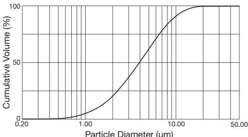
Le misure sono state effettuate con una soluzione al cloruro di sodio, per mezzo di un metodo a diffrazione laser.
